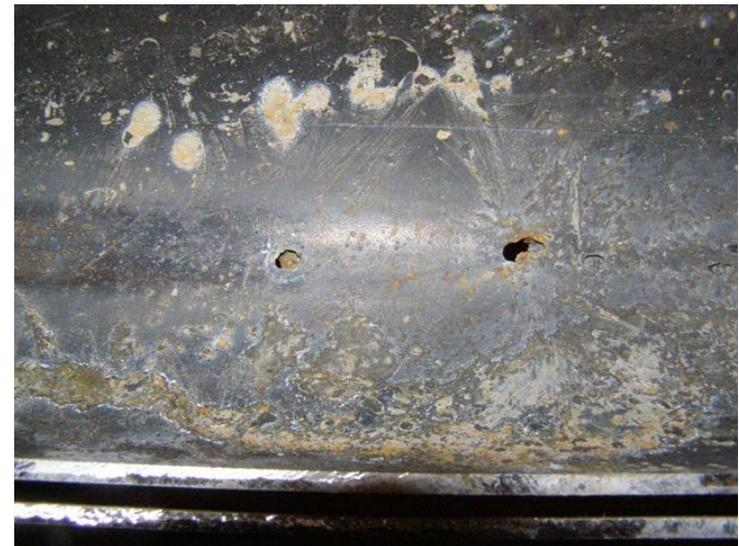
Corrosão por pite na face interna de um duto (imagem à esquerda) e falha causada por este tipo de corrosão (imagem à direita). Fonte: <http://www.ryscocorrosion.com/gallery/>
